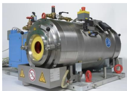
Instalații pentru controlul automat al barelor și țevelor
